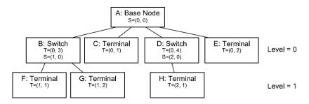
Figure 4—12: PLC PRIME tree example
